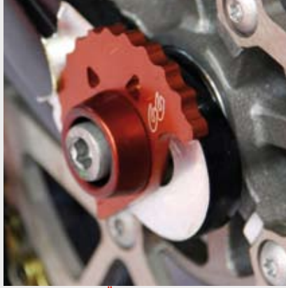
KETTENSANNER GEFRÄST UND ROT ELOXIERT
